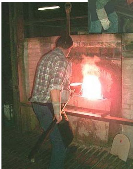
Erschmelzen im Hafenofen und Eingießen in die Form (Glashütte Lamberts)
